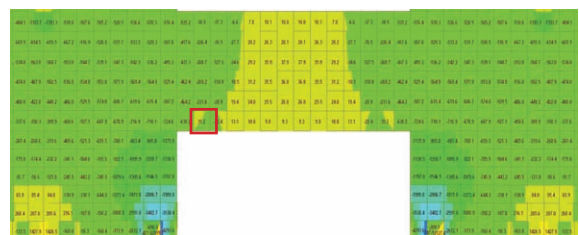
그림 13. 최대 응력(Stress) \sigma_{xy\max} = 35.2 \text{ kN/m}^2
